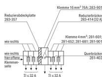
Aufbaubeispiel „Brücken mit Reduzierbrückern von Reihenklemmen 16 mm<sup>2</sup> auf Reihenklemmen 4 mm<sup>2</sup> mit Reduzierbrücken 283-414“
