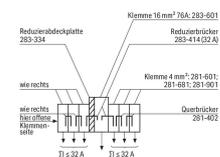
Aufbaubeispiel „Brücken mit Reduzierbrückern von Reihenklemmen 16 mm<sup>2</sup> auf Reihenklemmen 4 mm<sup>2</sup> mit Reduzierbrücken 283-414“
