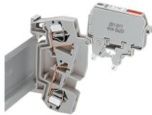
Auch bei senkrechter Montage der Klemmen ist die sichere Verrastung des Sicherungshalters in ausgeschwenkter Endposition gewährleistet.
