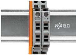
Sicherungs- oder Trennklemmen mit 8mm-Klemmenbreite können direkt aneinandergereiht werden. Am Ende der Klemmenleiste oder wenn **keine** Sicherungs- oder Trennklemme folgt ist eine Abschluss- bzw. Zwischenplatte zu verwenden.
