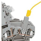
Eingangsseitige Spannungsprüfung, wahlweise mit in den Brückerschlitz eingestecktem Prüfadapter (280-404 Abb.) oder Prüfstecker (281-407)
