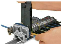
Zum Auslösen der Rastsperrung die Griffe über den Rastpunkt hinweg zusammendrücken. Betätigungszange von der Klemme nehmen und auf die nächste Klemme umsetzen.
