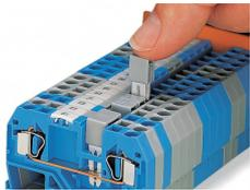
Brücken mit Querbrücken Querbrücken bis zum Anschlag hinunterdrücken.
