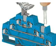
En fonction du type de bornes, on peut ponter horizontalement les mêmes niveaux de bornes adjacentes à l'aide de contacts de pontages horizontaux WAGO ou relier les trois étages entre eux au moyen de contacts de pontages verticaux WAGO, de manière à obtenir une borne de passage à 6 conducteurs.
