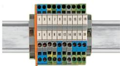
Bei einer Klemmenbreite von nur 5 mm ergibt sich ein effektives Teilungsmaß für Klemmen gleicher oder unterschiedlicher Potentiale von nur 2,5 mm bei einem Querschnittsbereich 0,08 ... 2,5 mm<sup>2</sup>!
