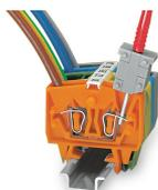
Prüfen über CAGE CLAMP®-Anschluss an der Stromschiene – möglicher Nennstrom 6 A; Durch CAGE CLAMP®-Betätigung können einzelne Prüfkontakte geklemmt werden. Die maximale Prüfspannung beträgt 400 V.
