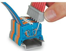
Tippkontaktierung, über die Feder des CAGE CLAMP®-Anschlusses, begrenzt den Nennstrom auf maximal 0,5 A und die maximale Prüfspannung auf 48 V; die Prüfstifte sind nicht berührungsgeschützt.
