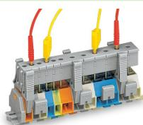
Die Prüfsteckerleisten lassen sich zum Prüfvorgang – auch bei angeschlossenen Leitern – auf die Klemmenleiste auf-schnappen. Da die Kontaktierung per Tippkontakt an den CAGE CLAMP®-Anschluss aus Federstahl erfolgt, bleibt diese Prüfmethode auf einen Nennstrom bis maximal 0,5 A beschränkt.
