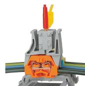
Les barrettes de modules de fiche de contrôle peuvent être encliquetées facilement, même sur les bornes déjà câblées. Étant donné que le contact s'effectue par contact direct sur le ressort CAGE CLAMP® en acier, le courant nominal est limité à 0,5 A.
