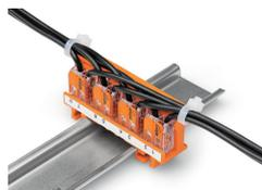
Zugentlastung durch Kabelbinder am Adapter, quer zur Klemmenanschlussrichtung; Klemmstellenkennzeichnung durch Beschriftungstreifen (210-334)
