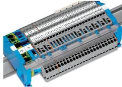
Le capot transparent de la barre collectrice (réf. 777-303) offre une protection contre les contacts accidentels en permettant toutefois de distinguer si les bornes sont connectées à la barre collectrice.
