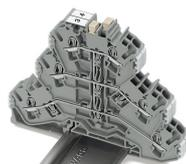
Le contact de pontage vertical pour la gamme de bornes sur rail TOPJOB®S relie deux ou trois niveaux entre eux en bornes à deux/trois étages. Puisqu'il s'agit d'un contact de pontage vertical à deux étages (2002-492) ou d'un contact de pontage vertical à trois étages (2002-493), un repérage visible « 2 » et « 3 » signale le nombre d'étages pontés.
