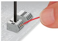
La connexion de câbles multibrins dans des espaces confinés n'est pas aisée, sauf si vous utilisez les barrettes à bornes de la série 218. Leurs points de serrage peuvent être maintenus ouverts avec un curseur d'actionnement intégré.
