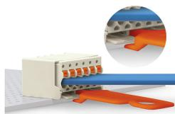
Déconnexion avec outil de déverrouillage. Placer l'outil de déverrouillage sur la languette de verrouillage du connecteur femelle.
