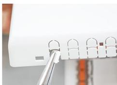
Abdeckung der Kabeleinführung aus dem Deckel ausbrechen.
