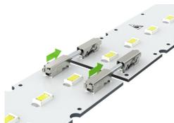
Connexion/déconnexion des circuits imprimés – Positionner les circuits imprimés sur une surface plane et emboîter mutuellement de manière droite (axiale) Pour déconnecter à l'aide de l'outil de manipulation, ouvrez les bornes pour vous aider. (max. 5 opérations de connexion/déconnexion).
