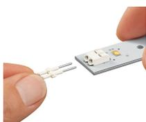
Enficher l'élément de raccordement dans la borne.
