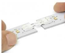
Connexion/déconnexion des circuits imprimés – Positionner les circuits imprimés sur une surface plane et emboîter mutuellement de manière droite (axiale) et retirer (max. 10 opérations de connexion/déconnexion).
