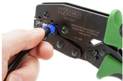
Introduire le conducteur muni de l'embout d'extrémité dans la pince de sertissage.
