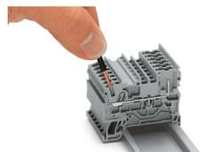
La connexion Push-in CAGE CLAMP® permet l'insertion directe de conducteurs rigides et de conducteurs souples munis d'embout d'extrémité.
