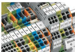
Klemmen X-COM®S-SYSTEM können mit den Brückersystemen der TOPJOB®S-Klemmen gebrückt werden. Über eine Abschlussplatte ist auch eine Verbindung zu TOPJOB®S-Klemmen möglich. Klemmen der Serien 2020 und 2022 können untereinander kombiniert werden. Beide Brückerspuren befinden sich auf einer Ebene.
