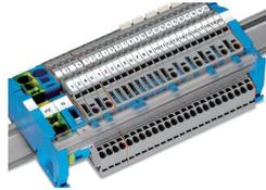
Sammelschienen sind in Sammelschienenträgern zu montieren. Dabei sind Sammelschienenenden in breiten Trägern (Bestellnr. 2009-305) oder in Einspeiseklemmen mit integriertem Sammelschienenträger einzurasten.
