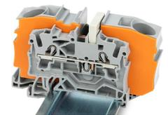
Reduzierbrücken schaffen den Übergang von querschnittsgroßen auf querschnittskleine Durchgangsklemmen, ohne Klemmstellenverlust. Sie sind z. B. interessant, wenn bei großen Leitungslängen der Spannungsfall gering gehalten werden soll, „vor Ort“ aber der Nennquerschnitt ausreicht.
