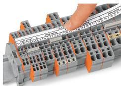
TOPJOB®S-Gruppenschildträger (Bestellnr. 2009-193) hier bestückt mit Beschriftungsstreifen, verwendbar für alle TOPJOB®S-Reihenklemmen der Serien 2000 bis 2016. Nicht über eine Abschlussplatte hinweg setzen!
