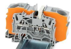
Reduzierbrücker schaffen den Übergang von querschnittsgrößen auf querschnittskleine Durchgangsklemmen, ohne Klemmstellenverlust. Sie sind z. B. interessant, wenn bei großen Leitungslängen der Spannungsfall gering gehalten werden soll, „vor Ort“ aber der Nennquerschnitt ausreicht.
