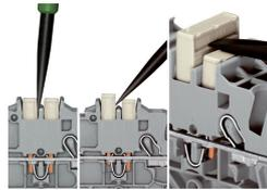
Kammbrücker einsetzen und bis zum Anschlag hinunterdrücken.
