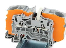
Reduzierbrücker schaffen den Übergang von querschnitts-großen auf querschnitts-kleine Durchgangsklemmen, ohne Klemmstellenverlust. Sie sind z. B. interessant, wenn bei großen Leitungslängen der Spannungsfall gering gehalten werden soll, „vor Ort“ aber der Nennquerschnitt ausreicht.
