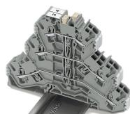
Die Vertikalbrücker für das TOPJOB®S-Reihenklempenprogramm verbinden in Doppel- und Dreistockklemmen zwei beziehungsweise drei Ebenen miteinander. Ob es sich um einen Doppelstock-Vertikalbrücker (2002-492) oder einen Dreistock-Vertikalbrücker (2002-493) handelt, signalisieren die auch im gesteckten Zustand gut sichtbaren Ziffern „2“ und „3“.
