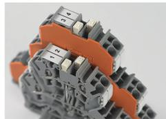
Die Vertikalbrücke für das TOPJOB®S-Reihenklennenprogramm verbinden in Doppel- und Dreistockklennen zwei beziehungsweise drei Ebenen miteinander. Ob es sich um einen Doppelstock-Vertikalbrücke (Bestellnr. 2002-492) oder einen Dreistock-Vertikalbrücke (Bestellnr. 2002-493) handelt, signalisieren die auch im gesteckten Zustand gut sichtbaren Ziffern „2“ und „3“.
