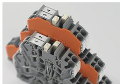
Die Vertikalbrücker für das TOPJOB®S-Reihenklemmenprogramm verbinden in Doppel- und Dreistockklemmen zwei beziehungsweise drei Ebenen miteinander. Ob es sich um einen Doppelstock-Vertikalbrücker (2002-492) oder einen Dreistock-Vertikalbrücker (2002-493) handelt, signalisieren die auch im gesteckten Zustand gut sichtbaren Ziffern „2“ und „3“.
