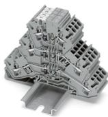
Dreistock-Diodenklemmen sind speziell für den individuellen Aufbau von Diodenschaltungen, wie z. B. Lampenprüf- und Sammelstörmeldesaltungen, konzipiert. Bei nur 5,2mm-Klemmenbreite wird eine hohe Packungsdichte erzielt. Der Einsatz von Kammbückern bietet zusätzlichen Spielraum für den Aufbau individueller Schaltungen.
