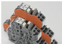
Die Vertikalbrücken für das TOPJOB®S-Reihenklennenprogramm verbinden in Doppel- und Dreistockklennen zwei beziehungsweise drei Ebenen miteinander. Ob es sich um einen Doppelstock-Vertikalbrücken (Bestellnr. 2002-492) oder einen Dreistock-Vertikalbrücken (Bestellnr. 2002-493) handelt, signalisieren die auch im gesteckten Zustand gut sichtbaren Ziffern „2“ und „3“.
