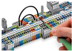
Leitungsbrücken bis zum Anschlag hinunterrücken. Für Umverdrahtungen Brücken mittels Betätigungswerkzeug heraushebeln.
