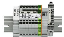
Mit dem Endlosbrücker der Serie 2002 können in nur einer Brückerspur endlos viele Klemmen mit einander verbunden werden. Die zweite Brückerspur bleibt frei.
