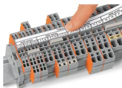
Porte-étiquettes de groupe TOPJOB®S (2009-193), ici avec bandes de marquage, utilisable pour toutes les bornes sur rail TOPJOB®S des séries 2000 à 2016. Ne pas placer par-dessus une plaque d'extrémité !
