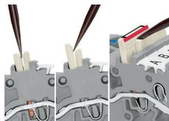
Schachtelbrücker mit dem roten Streifen innenliegend anordnen. Den Schachtelbrücker einsetzen und bis zum Anschlag hinunterdrücken.
