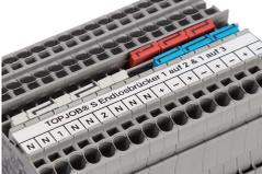
Mit dem Querbrücken für Endlosbrückung, von 1 auf 3, kann in einer Brückerspur endlos jede zweite Klemme gebrückt werden. Plus- und Minuspotentiale können so beispielweise aneinander vorbeigeführt werden.
