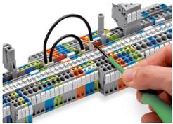
Leitungsbrücker bis zum Anschlag hinunterrücken. Für Umverdrahtungen Brücker mittels Betätigungswerkzeug heraushebeln.
